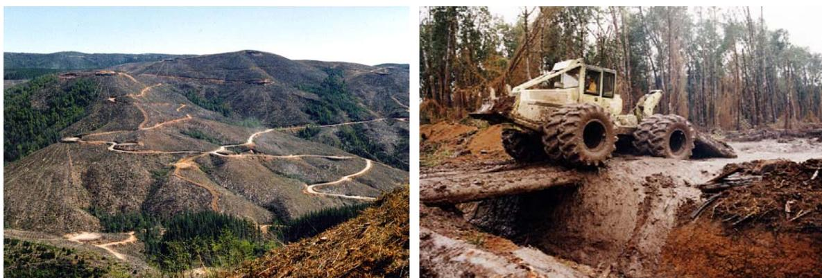
Figura 5.8. Izquierda: Corta a tala rasa que afecta a una superficie importante a nivel de cuenca. Derecha: Producción de sedimentos debido a unas operaciones de extracción de la madera sin controles adecuados.
