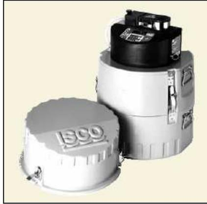
Figura 17.- Estación Automática ISCO Modelo 6712.
