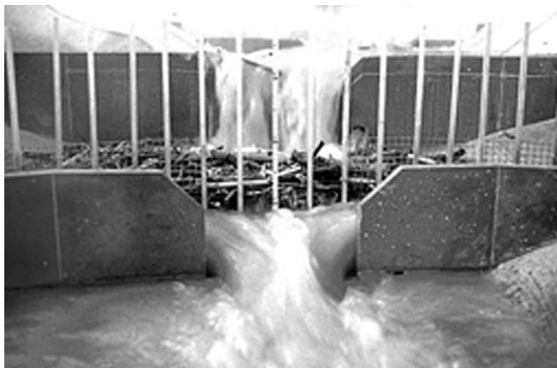
Figura 4.54 - Modelo físico para el estudio de la retención de la madera (Hergiswil, Suiza) ( http://www.vaw.ethz.ch ).
