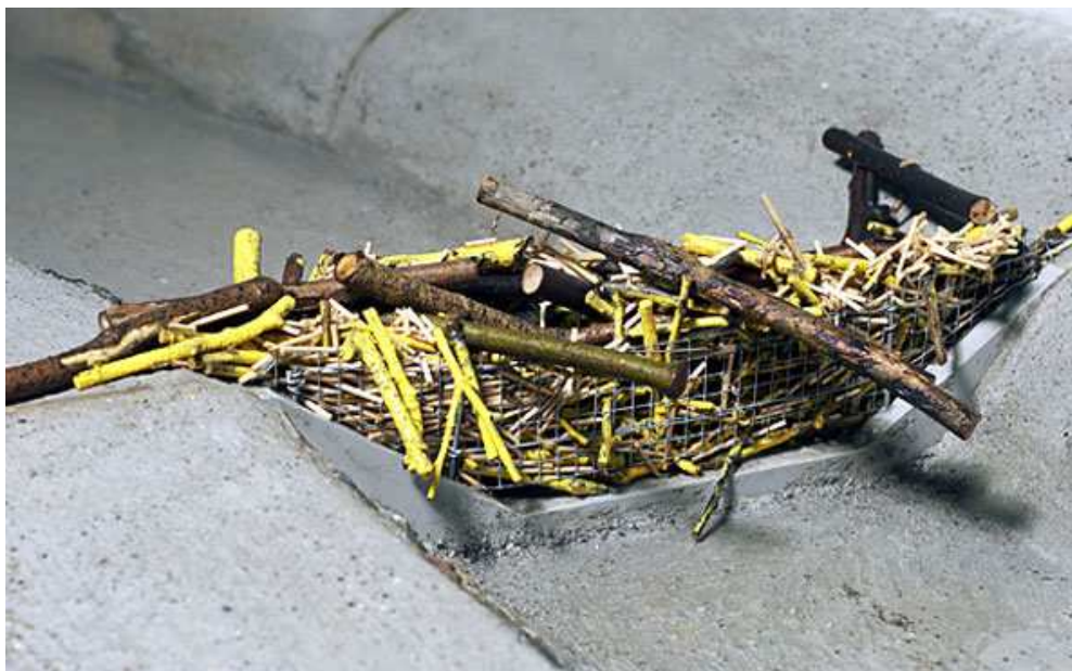
Figura 4.48 - Modelo físico para el estudio de la retención de la madera del río Enziwigger (cantón Luzern) ( http://www.vaw.ethz.ch )
