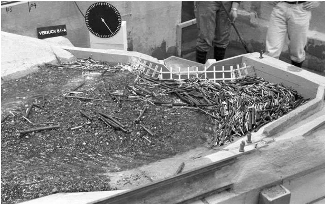
Figura 4.50 - Modelo físico de laboratorio para el estudio de la retención de detritos leñosos por parte de una trash rack en el torrente Dorfbach (Cantón Obwalden, Suiza) ( http://www.vaw.ethz.ch )
